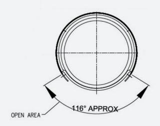
EXTENDED VISOR SHOWN MOUNTED CENTRALLY (CAN BE OFFSET TO THE LEFT OR RIGHT)
